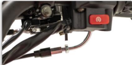
Ajuste do cabo do acelerador
