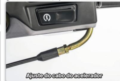
Ajuste do cabo do acelerador
