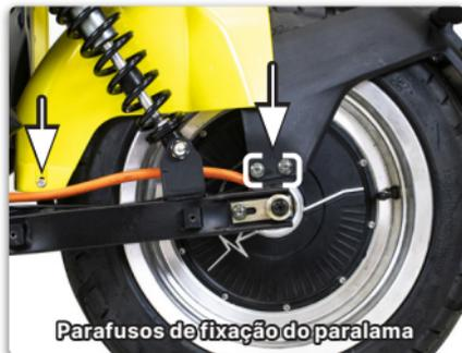
9. Remova os parafusos e porcas segurando a roda de ambos os lados;
