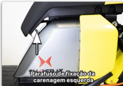
5. Remova os parafusos que seguram a tampa que cobre os fios do motor e sensor Hall;
