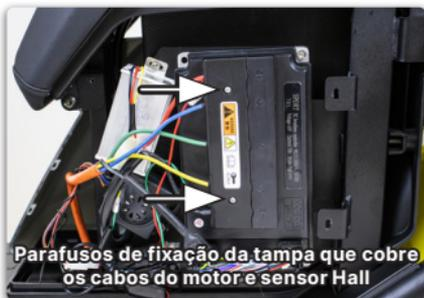
6. Remova os parafusos da tampa de segurança, em seguida desconecte os fios Azul, Verde e Amarelo do motor e desconecte o cabo do sensor Hall;
