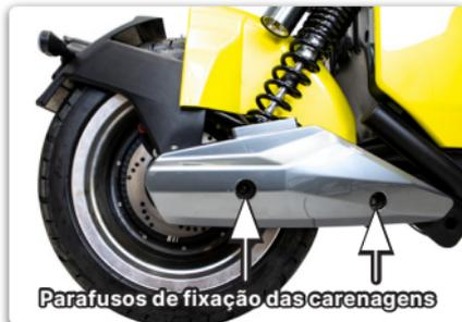
8. Remova os parafusos segurando o paralamas traseiro de ambos os lados, solte o da balança e apoie o de forma a não danificar os fios da lanterna;
