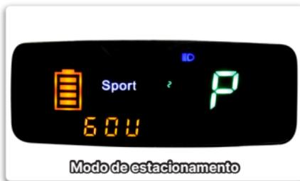
Enquanto no modo de estacionamento o Ciclo elétrico não poderá ser conduzido. Uma vez que o condutor esteja totalmente preparado para conduzir o patinete ele pode sair do modo de estacionamento recolhendo o cavalete lateral e então pressionar e segurar ambos os freios dianteiro e traseiro até o velocímetro aparecer no painel. A partir deste ponto o patinete poderá ser conduzido normalmente;
