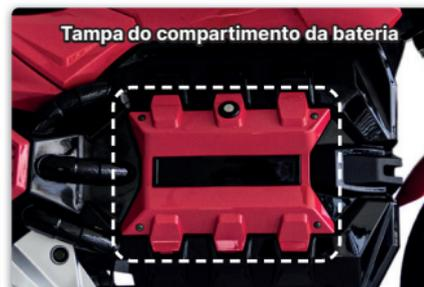
3. Desconecte a bateria, desligue o disjuntor e ligue a ignição e o farol por 10 segundos e por fim desligue a ignição novamente. (Esse procedimento irá descarregar cargas residuais dos capacitores do módulo). Assim que terminar este processo remova a bateria da motocicleta.
