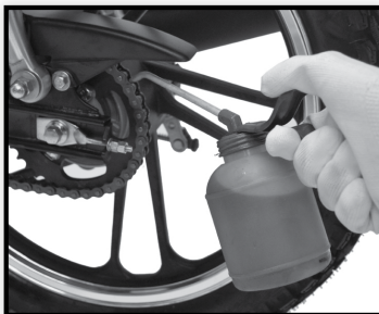
LUBRIFICAÇÃO DA CORRENTE DE TRANSMISSÃO.
